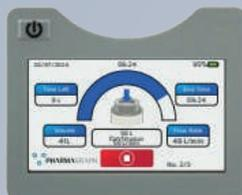
Un diseño liviano y ergonómico con un mango integrado. Cuenta con un mecanismo de retención para el tamiz. cabezal, lo que permite un fácil movimiento de la unidad entre lugares de muestreo. Los gráficos intuitivos se muestran en un ángulo. Pantalla táctil de 4,3 pulgadas. Mostrando claramente la muestra progreso y finalización. Placa regulable en altura y tamaño.
